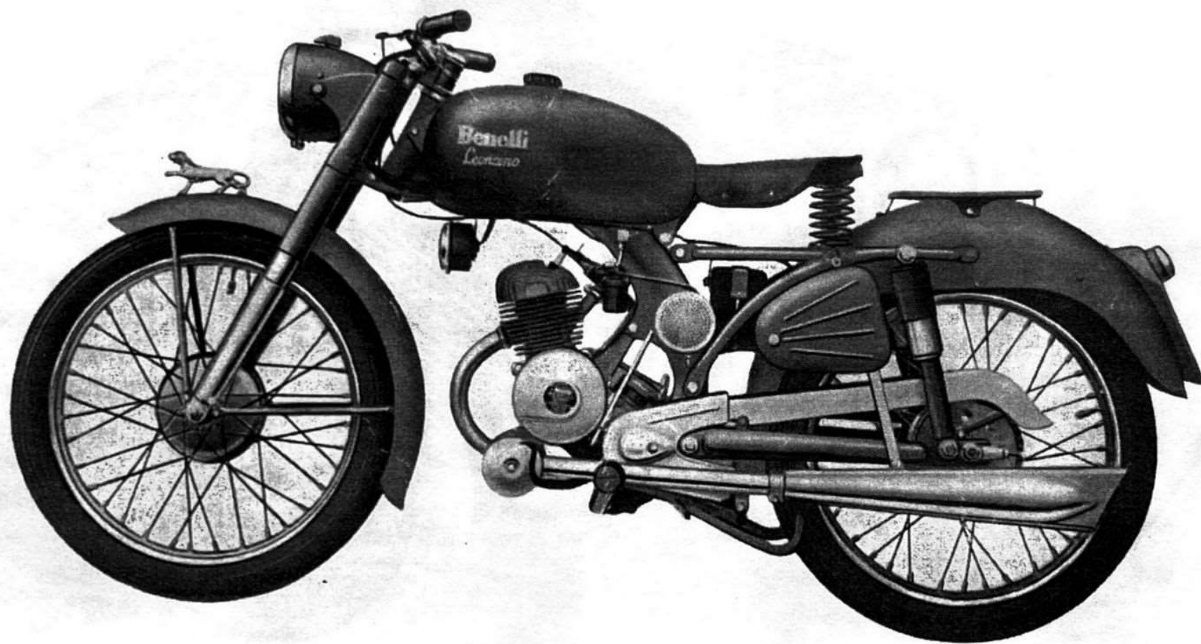
Fig. 2 - MOTOLEGGERA NORMALE 125 c.c. " LEONCINO ,, (lato volano magnete)
